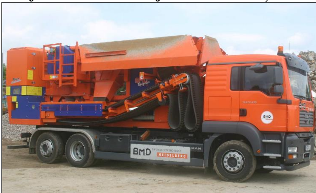
Figura 36 – Usina móvel de reciclagem de resíduos da construção civil.
