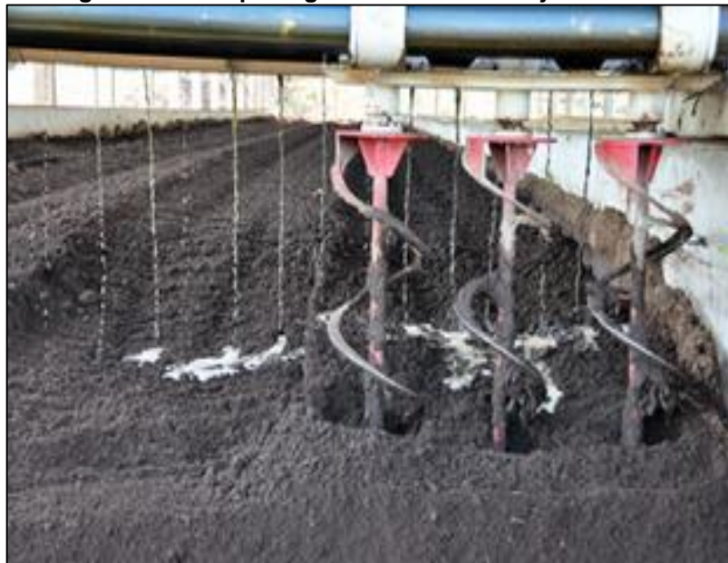
Figura 30 - Compostagem mecânica de dejetos suínos.
