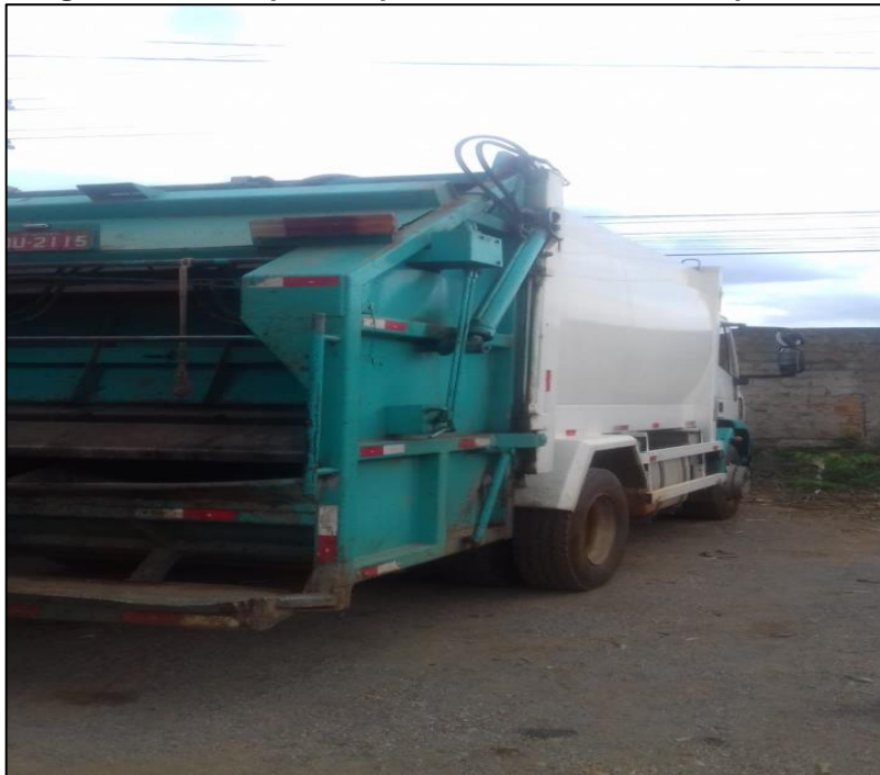
Figura 7 - Coleta porta-a-porta com caminhão compactador.
